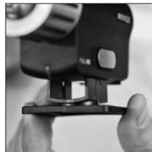
Fig. 7 Installazione della videocamera: inserire l'adattatore nel supporto di montaggio della videocamera.
