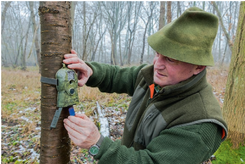
Die Kamera wird mittels eines Gurtes im Revier an Bäumen aufgehängt. Batterien sorgen für die Stromzufuhr. Je nach Einstellung (Video oder Bild), Bildauslösung sowie Außentemperatur kommt man damit einige Wochen durch. Fotos (2): Michael Breuer
