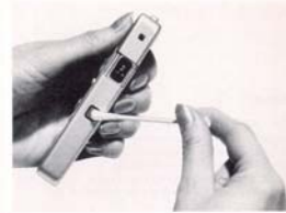
Objektivfenster mit Wattestäbchen reinigen – oder mit sauberem Lappchen (um ein Streichholz wickeln).
