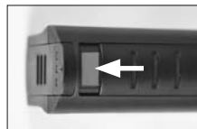
Abb. 3 Rote Markierung: Hauptschalter in der AN-Position
