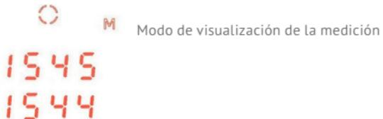
Con este ajuste, también se te muestra en la parte superior de la pantalla la distancia de la línea de visión hasta el objeto medido. En la parte inferior de la pantalla, se te muestra la distancia corregida por el ángulo de medición (distancia horizontal equivalente).
