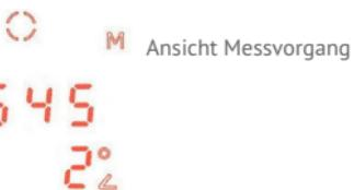
In dieser Einstellung wird dir im oberen Teil des Displays die Entfernung der Sichtlinie zum gemessenen Objekt angezeigt. Im unteren Teil des Displays wird dir der Winkel der Messung angezeigt. Ein Beispiel: Wenn du im Gebirge
