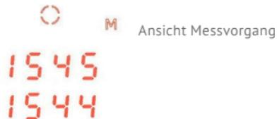
In dieser Einstellung wird dir im oberen Teil des Displays wieder die Entfernung der Sichtlinie zum gemessenen Objekt angezeigt. Im unteren Teil des Displays wird dir die um den Winkel der Messung korrigierte Entfernung angezeigt. (äquivalente horizontale Distanz)
