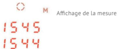
Ce réglage permet d'afficher dans la partie supérieure de l'écran la distance entre la ligne de visée et l'objet mesuré. La partie inférieure de l'écran indique la distance corrigée de la valeur de l'angle de mesure (distance horizontale équivalente).
